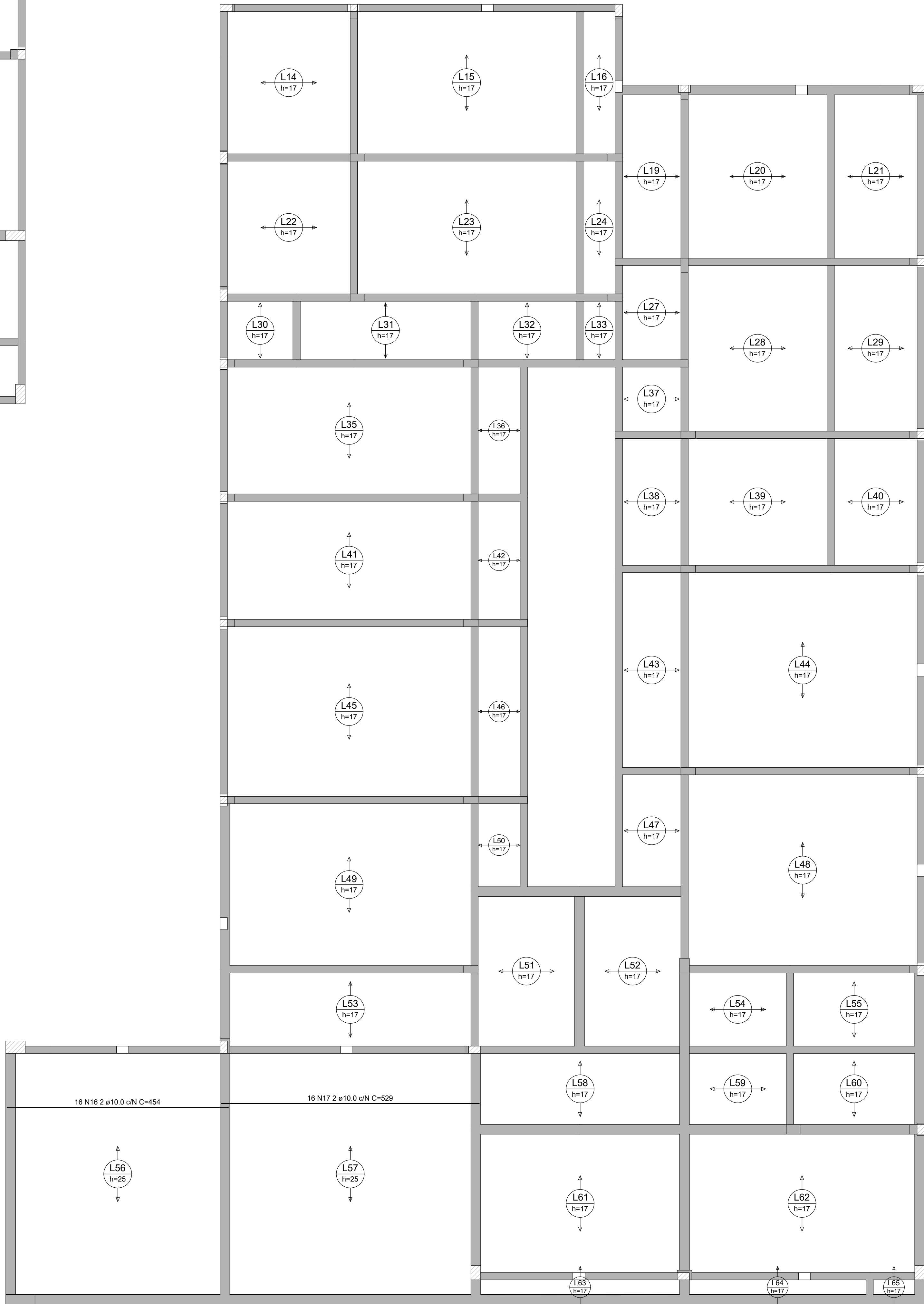
ARMAÇÃO POSITIVA DAS LAJES DO PAVIMENTO COBERTA (+3.70) (EIXO X)
