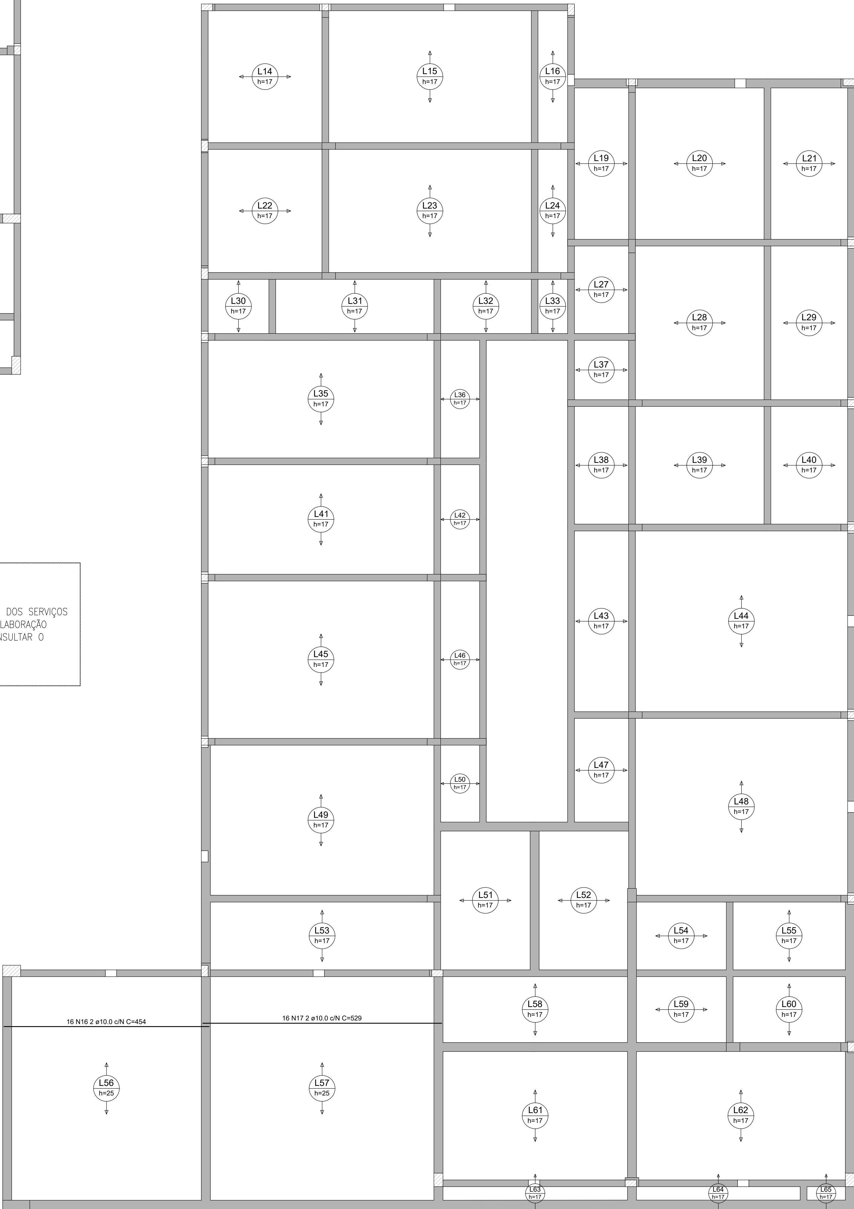
ARMAÇÃO POSITIVA DAS LAJES DO PAVIMENTO COBERTA (+3.70) (EIXO X) Escala 1:50
