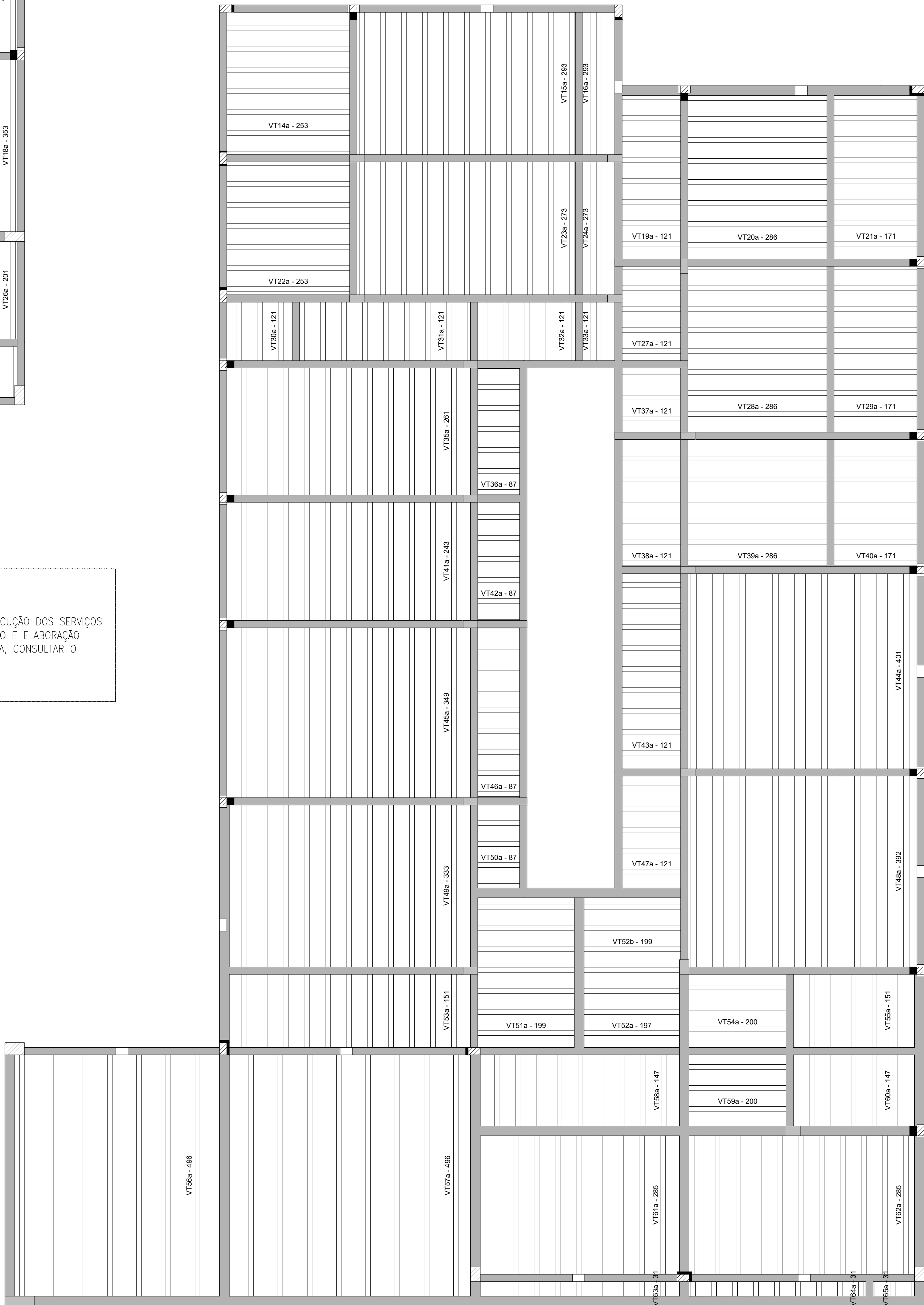
PLANTA DE VIGOTAS PRÉ-MOLDADAS
