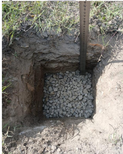
Figura 2 - Ensaio de infiltração realizado
