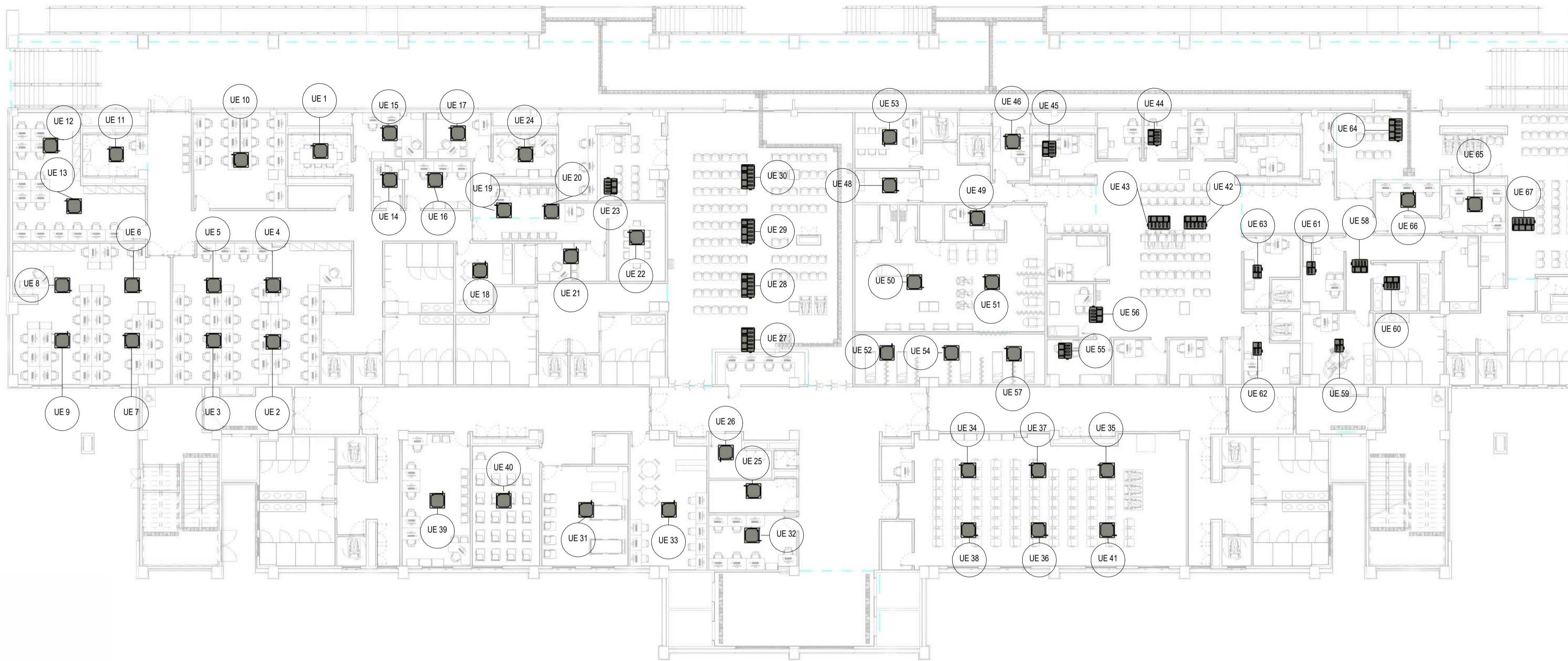
1 TÉRREO - EVAPORADORAS ESCALA 1:200
