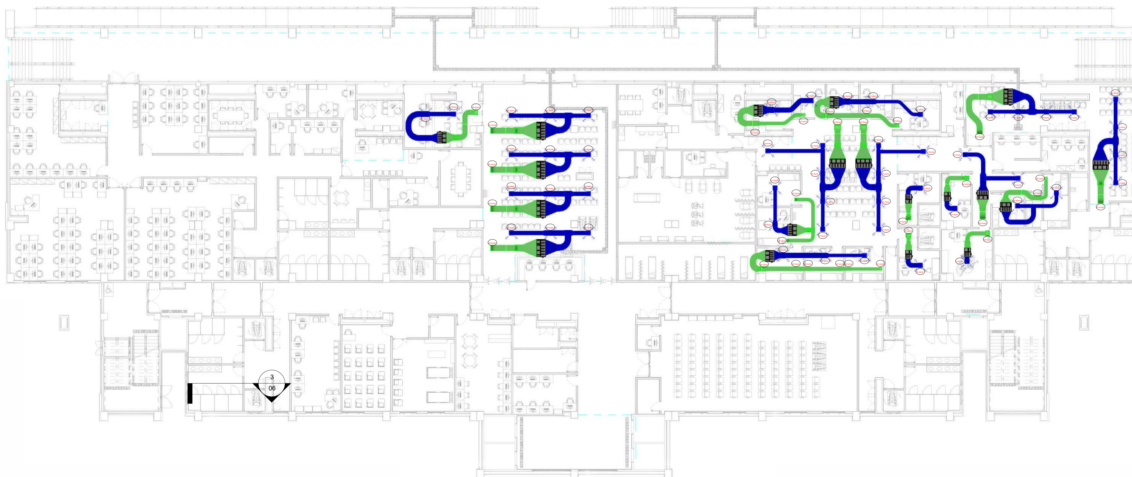
2 TÉRREO - DIFUSORES / GRELHAS DE RETORNO ESCALA 1:200
