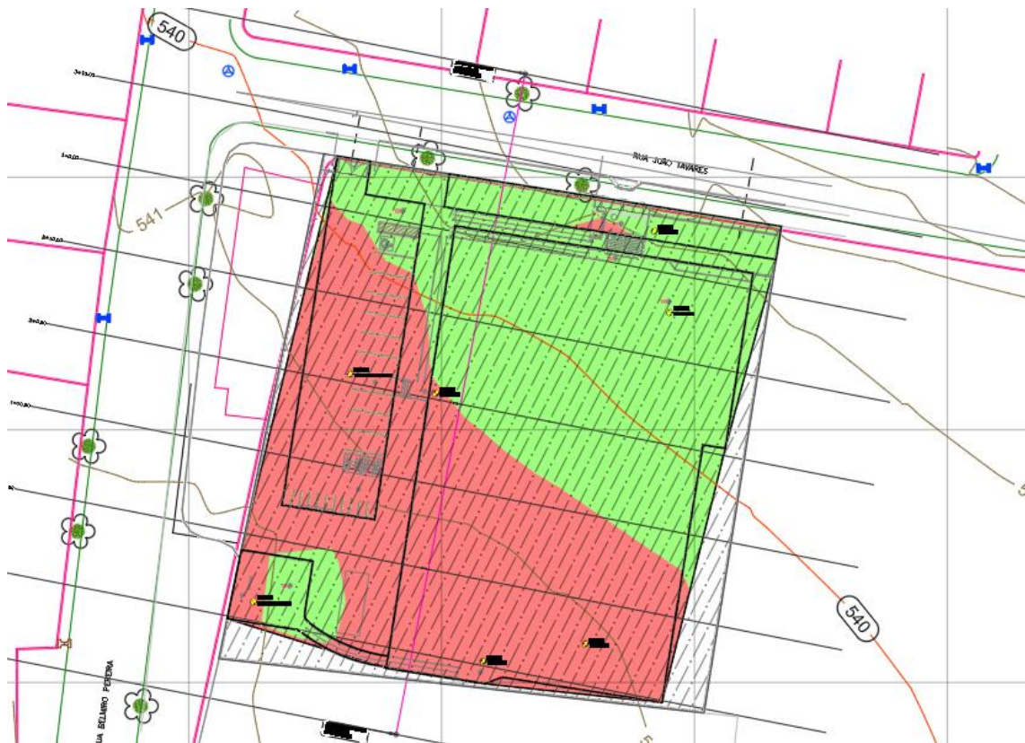
Figura 1 – Detalhe de Movimentação de terra
