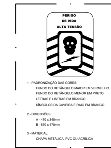
07 SUBESTAÇÃO AÉREA 13,8 kV - 300 kVA DETALHE - PLACA DE ADVERTÊNCIA INSTALADA NA CAIXA DE MEDIÇÃO ESCALA: SEM ESCALA
